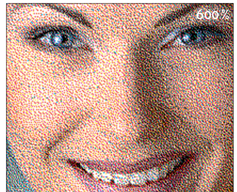
Offsetdruck frequenzmodulierter Raster [21 µm]
